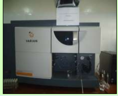
১৬) ইন্ডিউজড্ কাপল প্লাজমা-অপটিক্যাল এমিশন স্পেকট্রোমিটার (আইসিপি-ওইএস)ঃ বিভিন্ন এলিমেন্টের ঘনত্বকে পিপিএম, পিপিবি এবং পিপিটি লেভেলে পরিমাপের কাজে ব্যবহার করা হয়।
