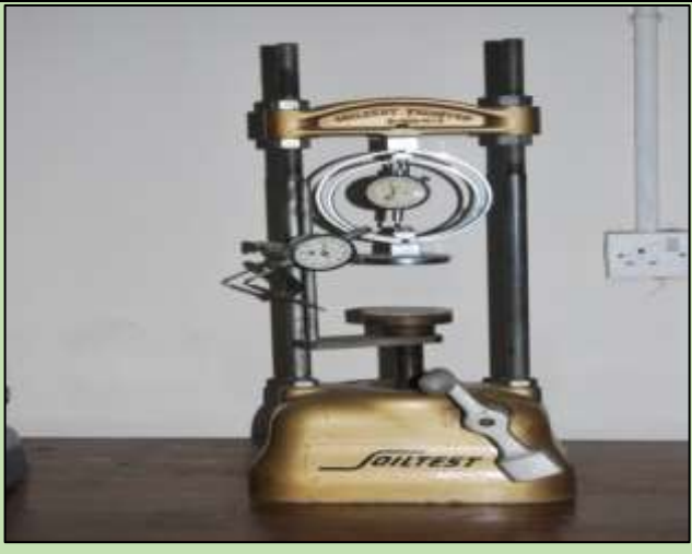
৮) আনকনফাইন্ড কমপ্রেশন যন্ত্রঃ মাটি নমুনার Strength নির্ণয়।
