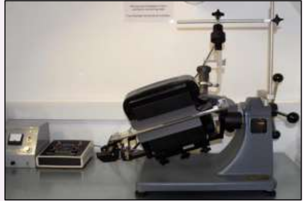
১০) চৌম্বকীয় পৃথকীকরণ যন্ত্রঃ চৌম্বকীয় সাস্পেন্ডিবিলাটি এর উপর ভিত্তি করে বিভিন্ন সাস্পেন্ডিবিলাটি সম্পন্ন মণিক আলাদা করা এই গবেষণাগারের কাজ। ডায়া চৌম্বকীয় জিরকন থেকে কোয়ার্টজ প্রভৃতির ঋণাত্মক সাস্পেন্ডিবিলাটি ভর মান -0.3 \times 10^{-6} সম্পন্ন মণিক এ যন্ত্র দিয়ে বিশ্লেষণ করা সম্ভব। জানামতে, বাংলাদেশে কেবলমাত্র জিএসবির গবেষণাগারে এ যন্ত্র রয়েছে।
