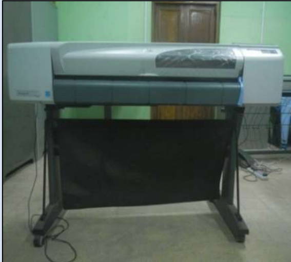
৩) প্লটার: বড় আকারের মানচিত্র প্রিন্টের জন্য ব্যবহৃত যন্ত্র (প্রস্থ ৪২" পর্যন্ত)।
