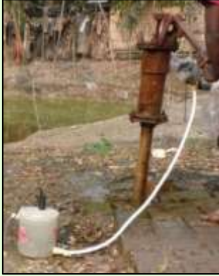
৭) ফ্লো থ্রু সেল (প্রোবসহ)ঃ পানির নমুনা সংগ্রহ ও পানির বিভিন্ন ভৌত প্যারামিটার পরিমাপ করার জন্য বিশেষভাবে তৈরী যন্ত্র যার মধ্য দিয়ে টিউবওয়েলের পানি প্রবাহিত করা হয় যেন তা বাতাসের অক্সিজেনের সংস্পর্শে না আসে।
