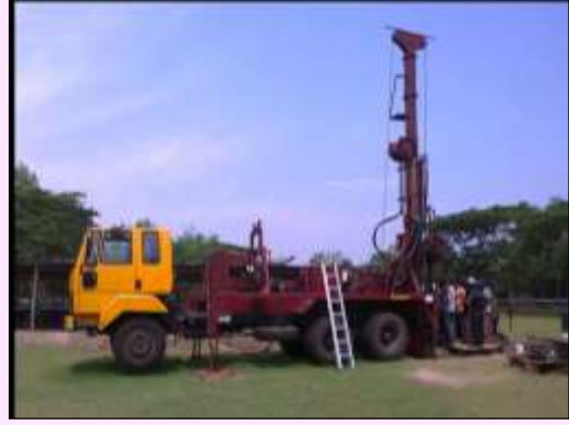
২) ট্রাক মাউন্টেড ড্রিলিং রিগ (এসইডিআই ড্রিল ১০০০)ঃ ২২০০ ফুট গভীরতা পর্যন্ত খননে সক্ষম।
