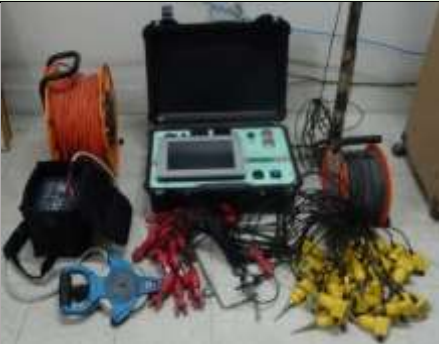
৩) স্যালো সাইসমিক সার্ভে (রিফ্লেকশন): ভূমিকম্প জরিপের জন্য মাটির প্রকৌশলগত গুণাগুণ নির্ণয়ে Shear Wave Velocity Profiling করা যা ভবিষ্যতে ভূমিকম্প সহনীয় অবকাঠামো নির্মাণে সহায়তা করবে।
